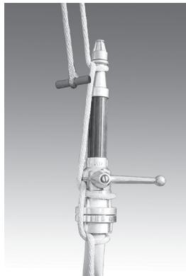
Je einen Mastwurf gelegt mit Halbschlag an C-Strahlrohr mit Schlauch
